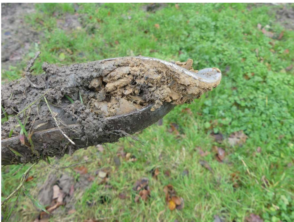
Figure 7 : nombreux matériaux exogènes dans le premier horizon, témoignant d'un remblai – sondage 2 (source : BE Nat')
